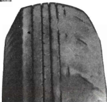
Se il consumo del battistrada è maggiore al centro (fig. 1), significa che abitualmente il pneumatico è gonfiato ad una pressione superiore a quella prescritta. Un consumo localizzato solo in un lato (fig. 2) sta a significare un angolo di inclinazione superiore al normale.
